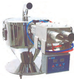
Autoselector para 2 tipos de materiales accionado por un switch
